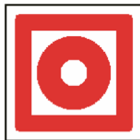
Identificación de la ubicación de Pulsador de alarma
