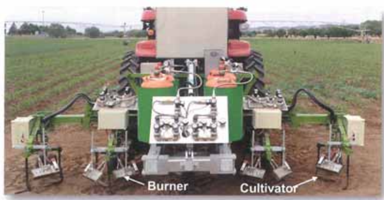
Figura 11. Apero combinado para el control mecánico de las malas hierbas en las entrelineas del cultivo y control térmico en la línea.
