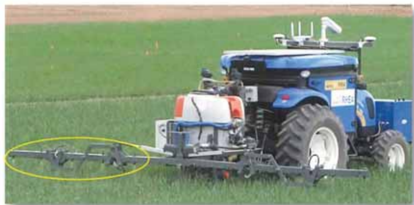
Figura 9. Pulverizador de precisión desarrollado para utilizar mapas de infestación obtenidos previamente, realizando tratamientos con una resolución espacial de medio metro.
