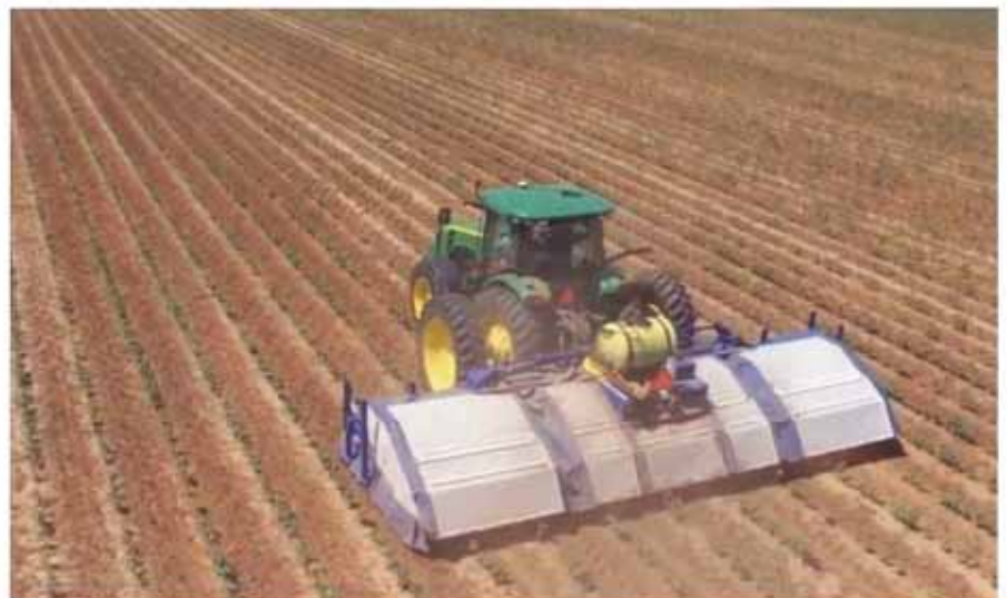
Figura 10. Pulverizador inteligente desarrollado y comercializado por BlueRiver Technology.
