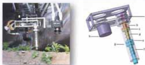
Figura 13. Escardador robótico inteligente Bonirob.
