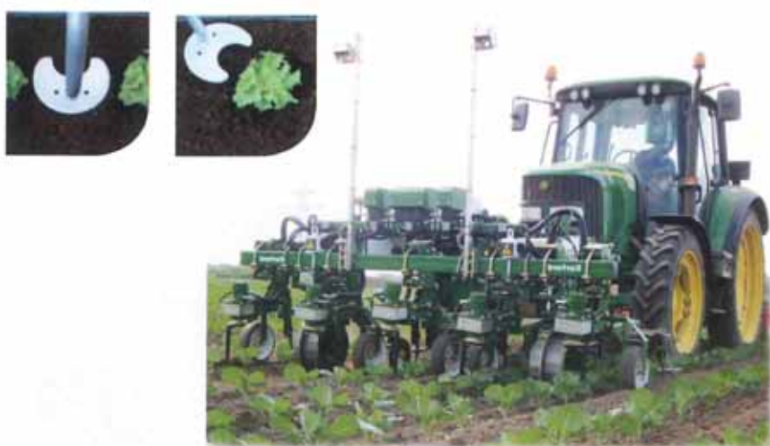
Figura 12. Equipo Robocrop para el control mecánico de las hierbas tanto en la línea como en las entrelineas.
