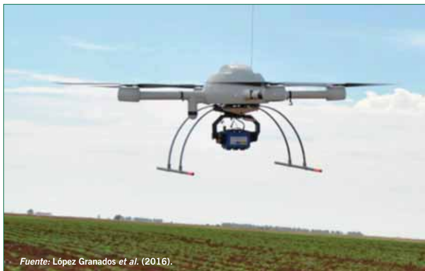
FIGURA 2 UAV DEL GRUPO IMAPING EQUIPADO CON SENSOR MULTIESPECTRAL (RANGO VISIBLE + INFRARROJO CERCANO) INICIANDO EL VUELO EN PARCELA DE GIRASOL
