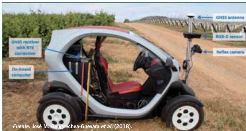
FIGURA 1 (B) PLATAFORMA TERRESTRE NO TRIPULADA MOSTRANDO SU SISTEMA SENSORIAL Y RESTO DE EQUIPOS
