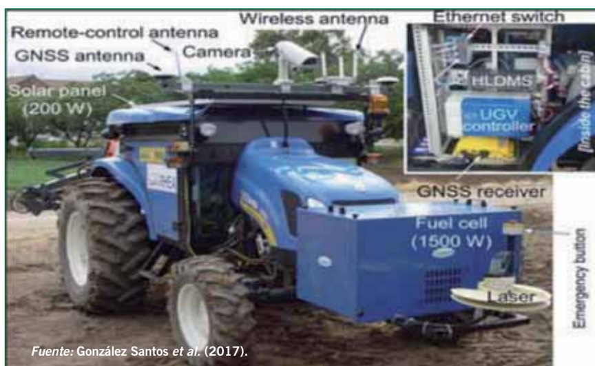
FIGURA 1 (B) PLATAFORMA TERRESTRE NO TRIPULADA MOSTRANDO SU SISTEMA SENSORIAL Y RESTO DE EQUIPOS
