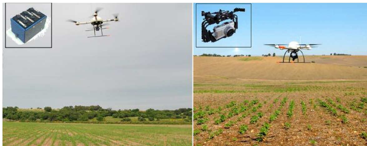
Figura 6. Un drone equipado con una cámara multi-espectral (izquierda) y con una cámara convencional de espectro visible (derecha).
