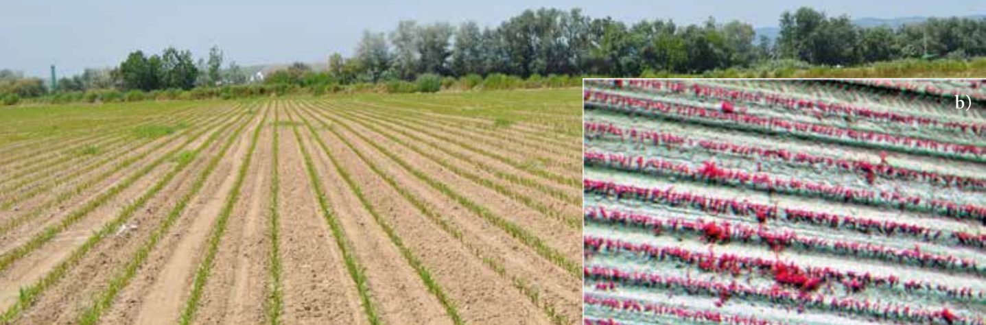
Figura 4. a) UAV equipado con sensor multiespectral volando una parcela de maíz infestada de rodales de malas hierbas en época temprana; b) Detalle de la imagen formada por las bandas Verde, Rojo e Infrarrojo Cercano sobre la parcela de maíz estudiada. Se pueden observar las líneas de cultivo y la presencia de malas hierbas entre las líneas.
